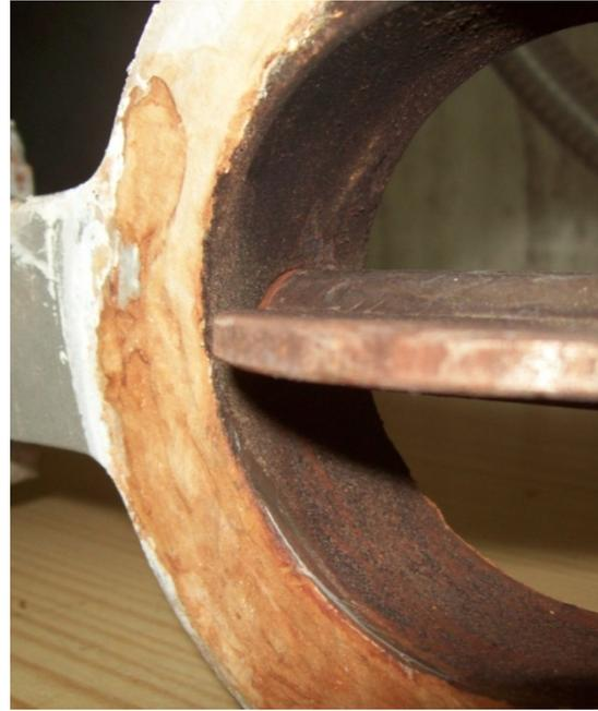
Abbildung 36: Abgasklappe, instandgesetzt (stark korrodiert)
