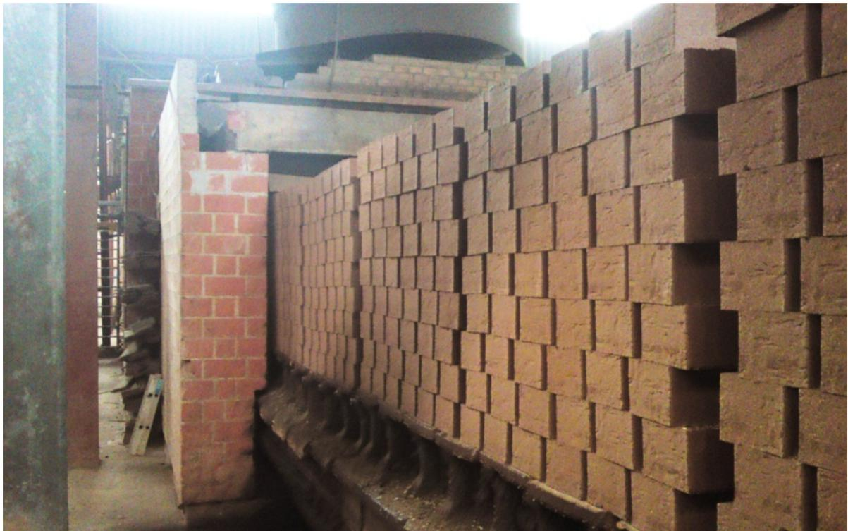
Abbildung 15: Ofenwagen beim Verlassen des Tunnelofens
