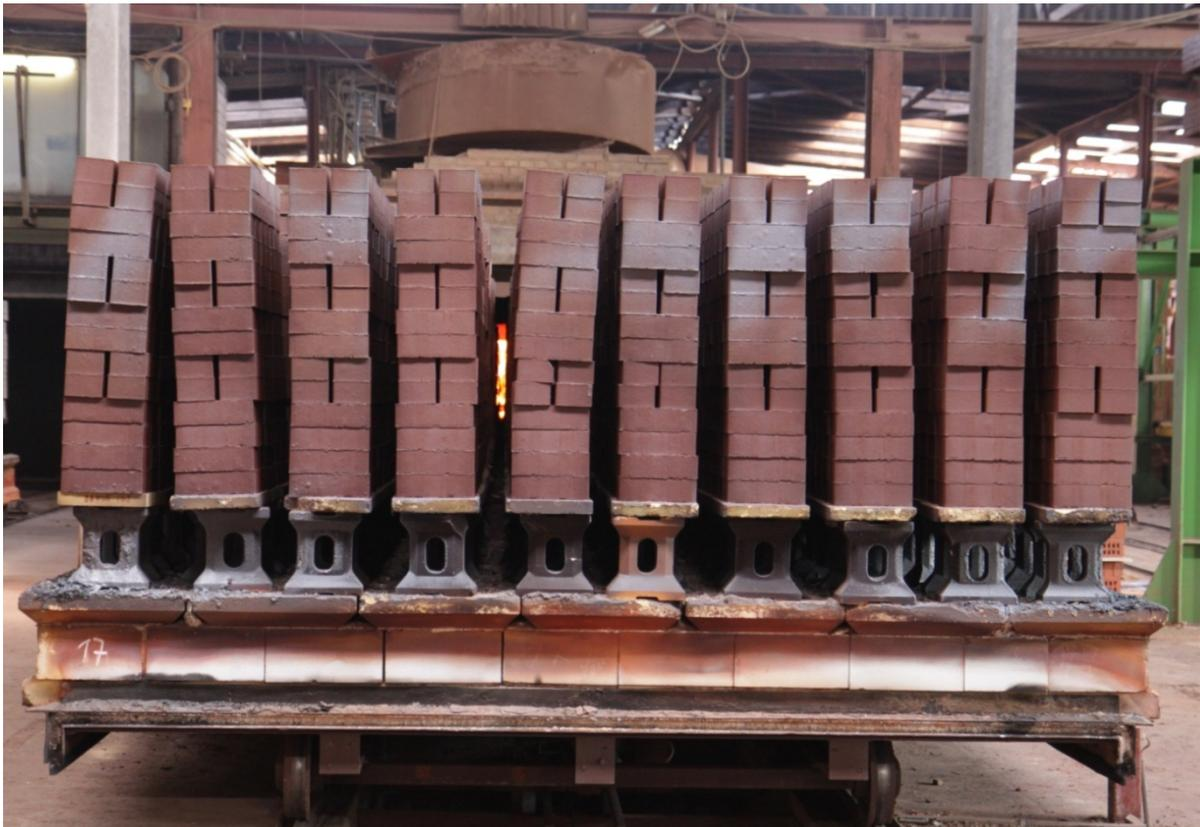
Abbildung 12: Ofenwagen mit Brennhilfsmitteln (Schamottesteine) und Ziegelbesatz
