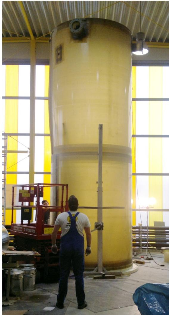
Abbildung 4: Bau eines 25m<sup>3</sup> Pufferspeichers aus glasfaserverstärktem Kunststoff (GFK) für ein BHKW
