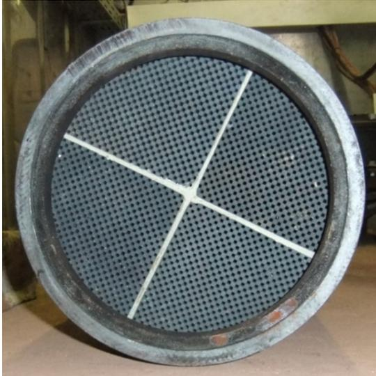
Abbildung 33: regenerierter Partikelfilter
