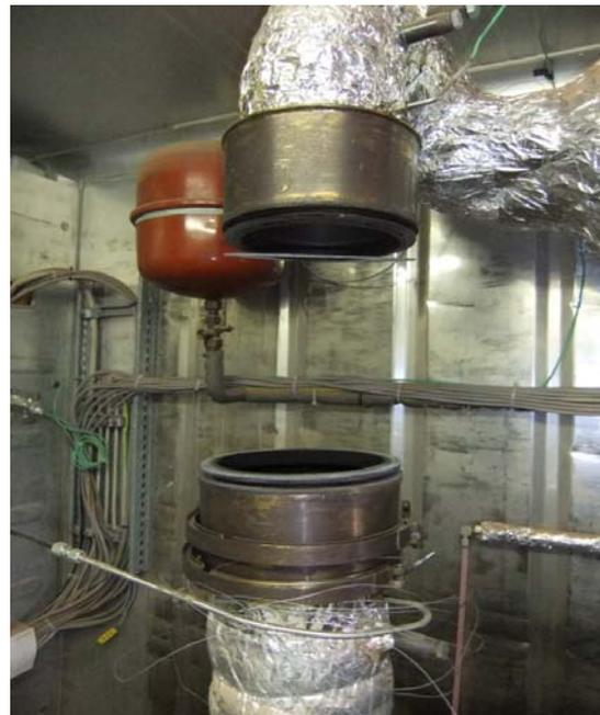
Abbildung 32: Partikelfilter, ausgebaut (externe Regeneration)
