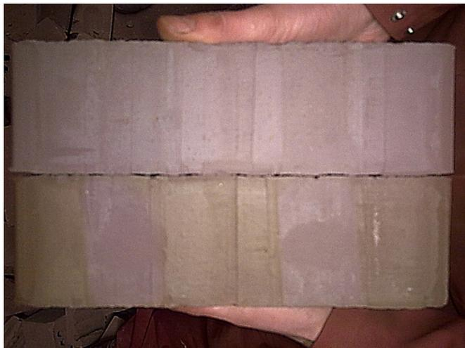
Abbildung 29: Nach dem Trocknen mit schwefelarmem Heizöl (unterer Ziegel) ist im Vergleich zum konventionell getrockneten Ziegel (oben) deutlich die nicht verfärbte Auflagefläche, mit der der Ziegelrohling auf dem Trocknergestell auflag, zu sehen.
