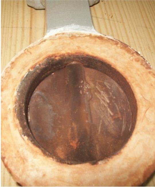
Abbildung 35: Abgasklappe, festgerostet
