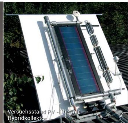
Versuchsstand PV - Thermie Hybridkollektor
