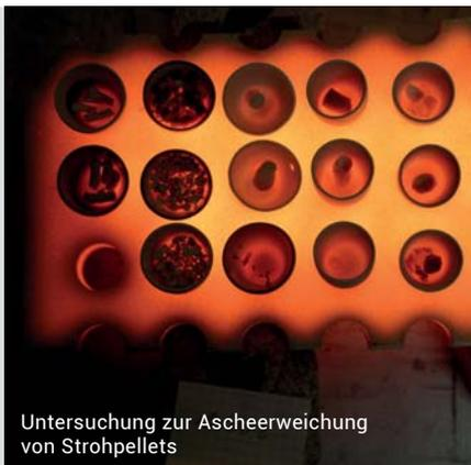
Untersuchung zur Ascheerweichung von Strohpellets
